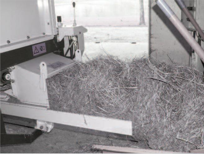
**La vis sans fin 400mm compacte et pousse le foin sur les tapis mécanisés**
