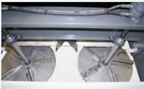
Équipement d'épandage à disques hydrauliques (vitesse réglable)
